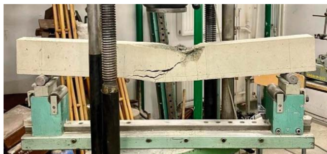
Rys. 8. Obraz zniszczenia belki 2
