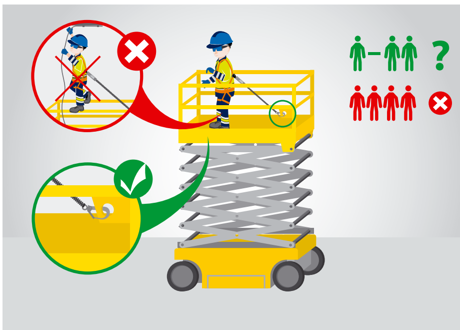
Rysunek 6. Przykład rozmieszczenia punktów kotwienia w podnośniku nożycowym.
