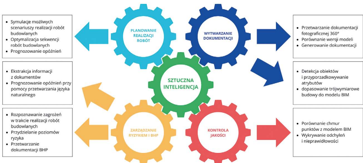
Rys. 1. Schemat integracji algorytmów sztucznej inteligencji z wybranymi obszarami zarządzania procesem realizacji robót budowlanych
