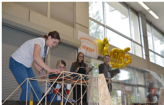
Rys. 3. Widoczne ugięcie konstrukcji bezpośrednio przed wyczerpaniem nośności i utratą stateczności
