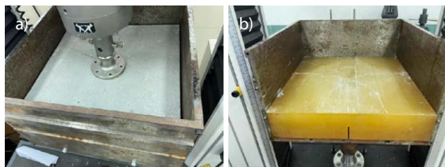
Rys. 2. Stanowisko badawcze: a) widok, b) podkładka poliuretanowa (zdjęcia własne)
