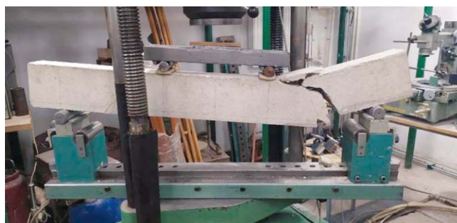
Rys. 9. Obraz zniszczenia belki 3
