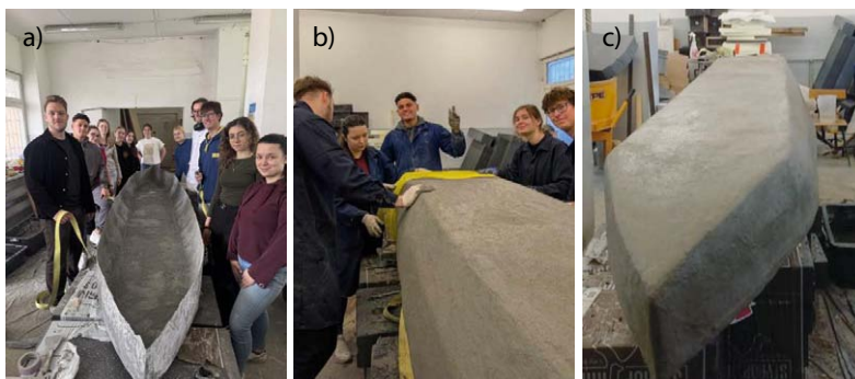
Rys. 4. Konstrukcja po rozformowaniu (a), konstrukcja po wykonaniu wzmocnienia w postaci siatki podtynkowej (b), canoe na etapie dalszej pielęgnacji (c) (zdjęcia własne)
