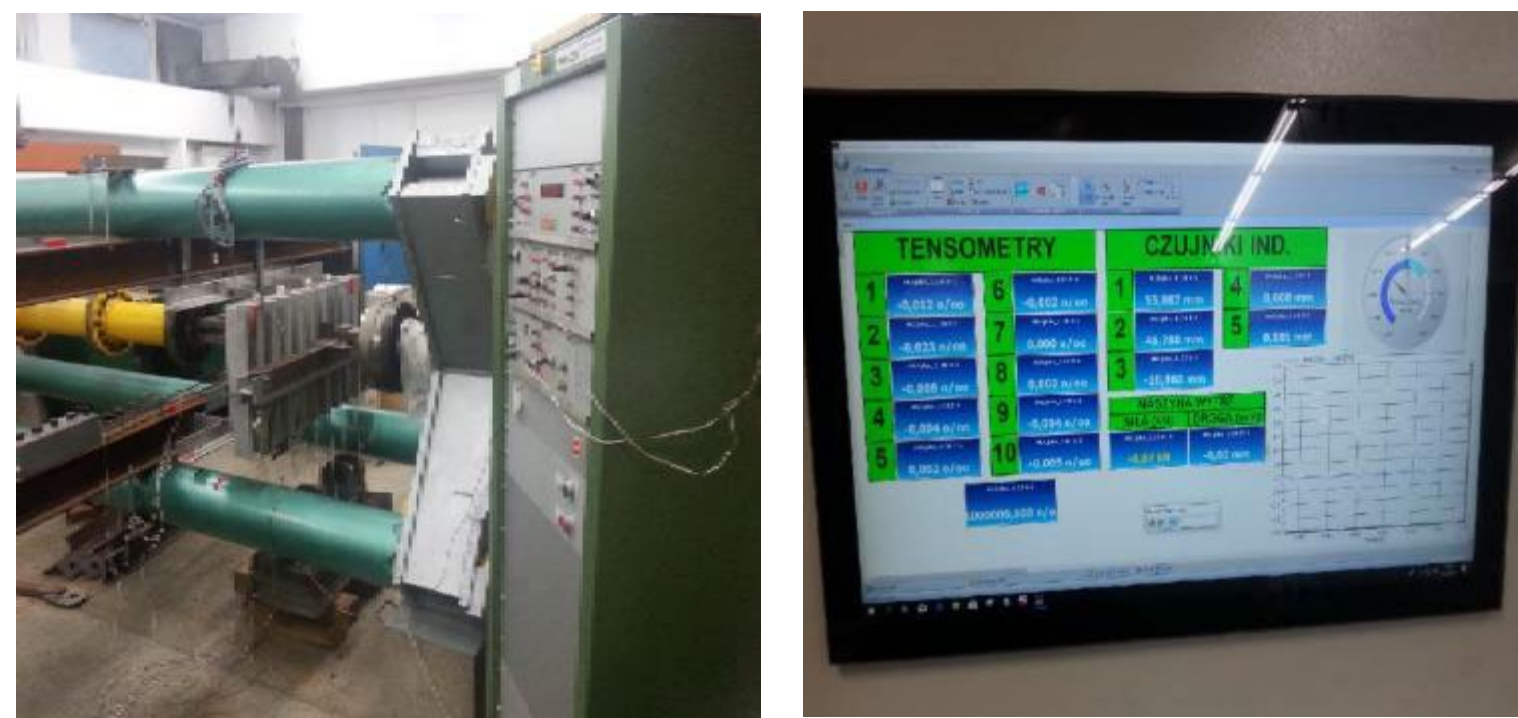
Pozioma maszyna wytrzymałościowa, podczas badania fragmentów elewacji wieżowca „Skyliner”
