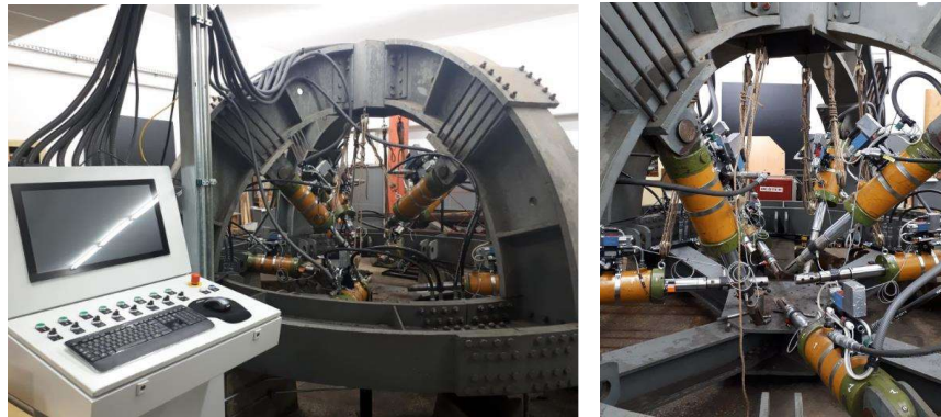
Przestrzenna maszyna wytrzymałościowa do badań węzłów
